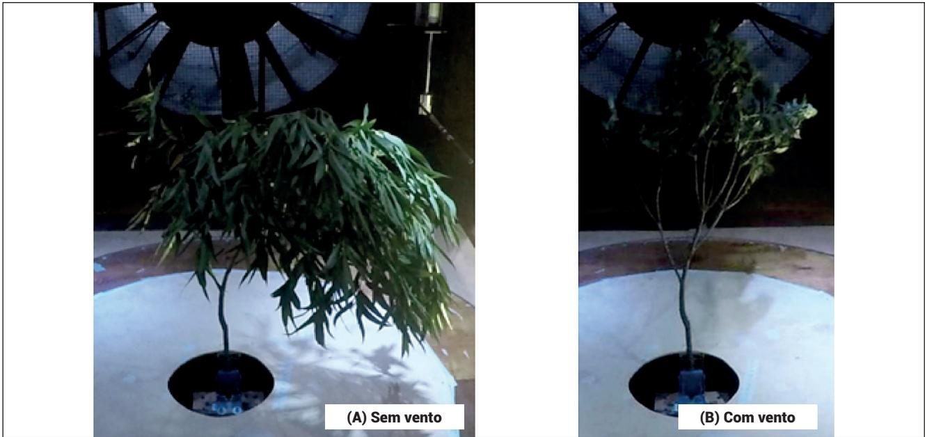
**Figura 3.** (Comparação das áreas vélicas de galho de eucalipto em situações (A) sem vento e (B) com vento de 13 m/s
